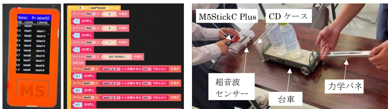
図 1. 左. M5StickC Plus の全体写真 中央. 使用したプログラミングの一部の画面 右. 実験の様子
