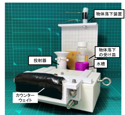
図 1 慣性力実験機 実験ごとにパーツを付け外しでき、 実験内容に集中できる
