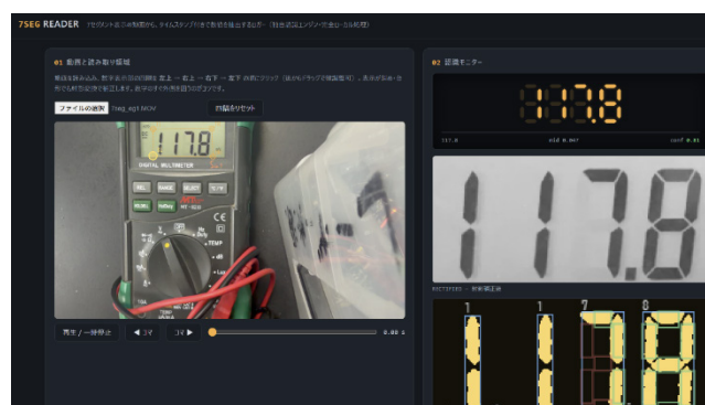
図4 測定器の7セグを撮影した動画から値の変化を自動データ化【7SEG Reader】
