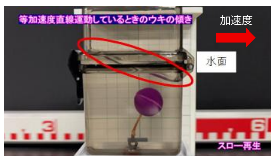
図 2 慣性力と浮力 浮力と慣性力の様子を水面の傾きと 同時に乗客視点で観察できる
