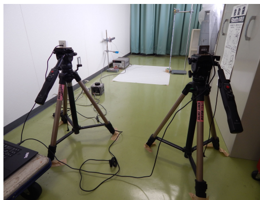
図 2 2 台の USB カメラの配置
