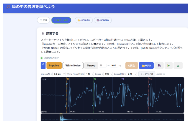
図2 管中の音波を USB マイクとスピーカーで探索【TubeScope】
