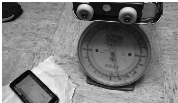
図1 エレベータの加速度の測定
