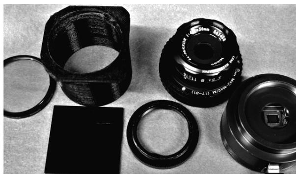
図1 紫外線カメラの構成部品
