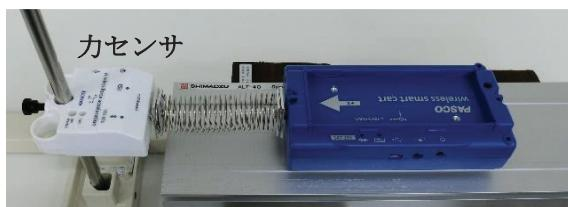
図5 ばねの両側を力センサに装着したもの
