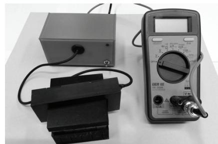
図 1. 装置全体像。測定試料とプローブ(左前), 本体(左後), テスター(右)。
