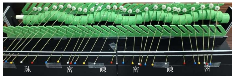
図2：装置全体の外観(横1m×奥行30cm×高さ13cm)
